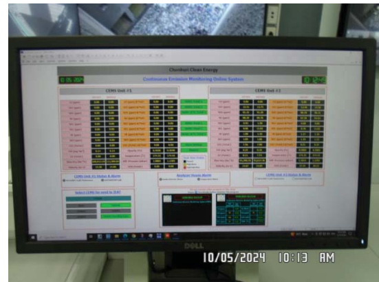
รูปที่ 12 หน้าจอ DCS ระบุค่าสัญญาณเตือนความผิดปกติจาก CEMs
